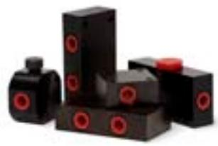
CEJN的输入输出模块能够同时连接几条液压管线，这使得单个泵能连接多种工具和压力表。该系列有5种不同的尺寸并且有不同的端口设计，具体请看单个模块的技术数据。材质为硬化钢镀黑锌。
